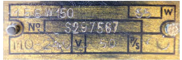
• Neutraal Philips-plaatje op het chassis van een Opta Radio (Löwe) 156W (= A52A-EVA), gefabriceerd in de Philipsfabriek in Suresnes (F).
