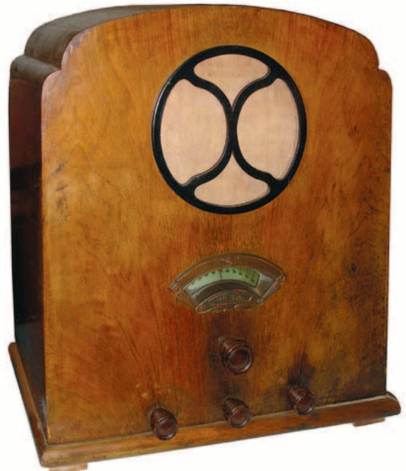
Weco Melodie, Weco-type 312, Biedermann catalogusnummer 5009, lampen: 24, 27, 47 en 80. Collectie: Radio Amateur Museum, Reusel.
