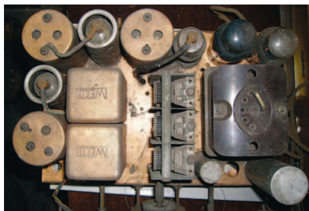
Nog niet geïdentificeerd 5-lamps toestel. Te oordelen naar de gebruikte componenten (spoelbussen, afstemschaal en condensatoren) is het een in België gebouwd Weco-toestel (naar schatting 1936). Net als bij een exemplaar van de Weco Melodie 374 zijn ook bij dit toestel condensatoren toegepast van het Oostenrijkse merk SATOR. Collectie en foto: Willy Nijs (B).
