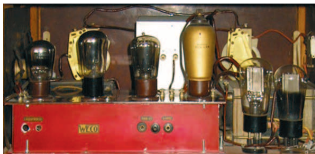
6-lamps Weco-toestel. nog te identificeren, uitgerust met twee gelijkrichtlampen. De kast lijkt op die van de Super Weco Duo in deel 2, maar is een stuk breder. Collectie en foto: Jeroen Landman.
