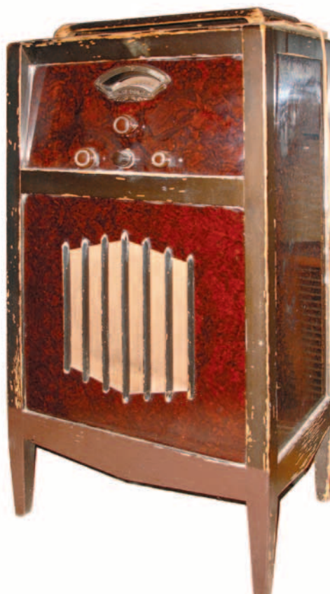
Nog niet geïdentificeerd 4-lamps Weco-toestel met een chassis dat grotendeels gelijk is aan het chassis 311, maar met extra aansluitingen aan de achterzijde. Het front van het ontvangergedeelte is enigszins naar achter hellend gemonteerd. Collectie: Radio Amateur Museum, Reusel.
