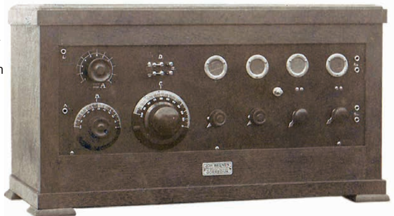
• Foto van ontvanger van het type A4 (0V3) met 4 lampen.
