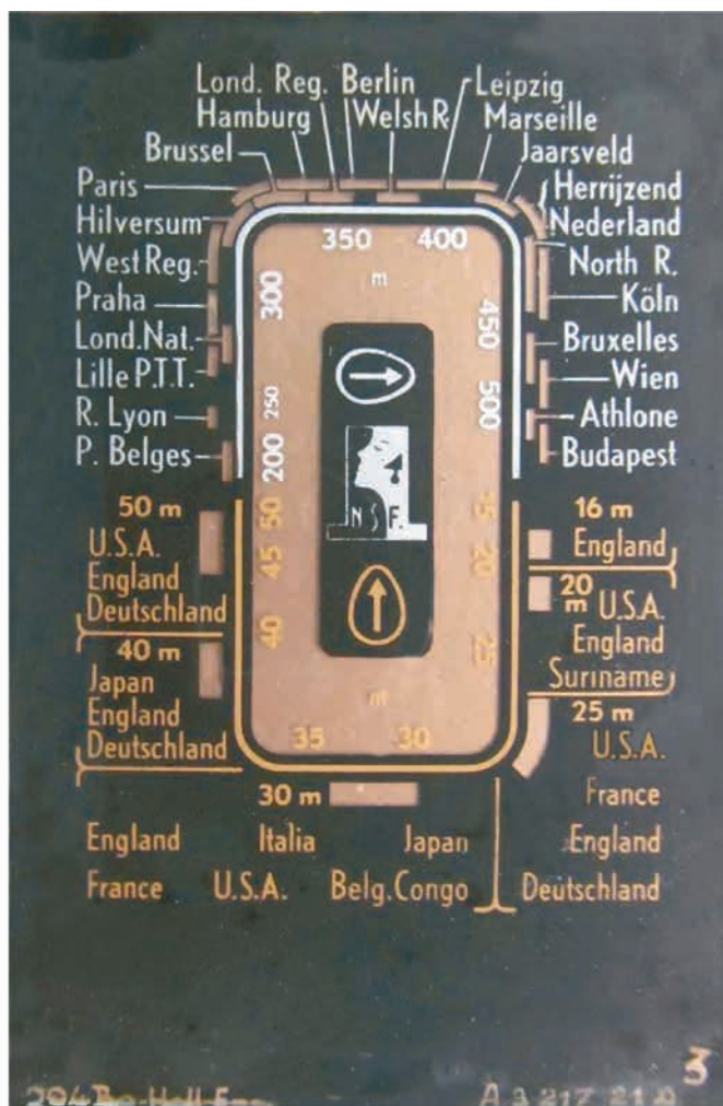
Afstemschaal van late uitvoeringen van de in België gebouwde 204U (links) en daarvan afgeleide NSF H126U (rechts). De afstemschalen zijn op het logo na identiek. De schaalidentificatie en bestemmingsaanduiding links onder is '204 Be-Holl-Eng', het codenummer rechts onder is A3 217 21.0. Een schaalnummer ontbreekt hier.
