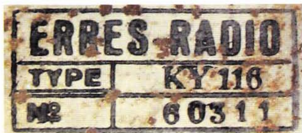
Opgedrukt typeplaatje op afstemcondensator met serienummer (KY116,117,119,120 en 129).
