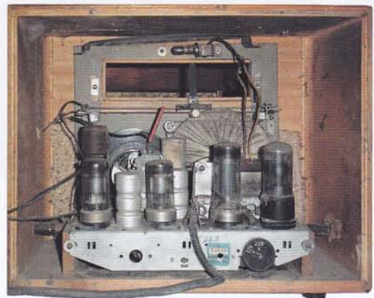
Velora 64B, achterzijde met chassis van de Philips 209U. Collectie Jeroen Landman.
